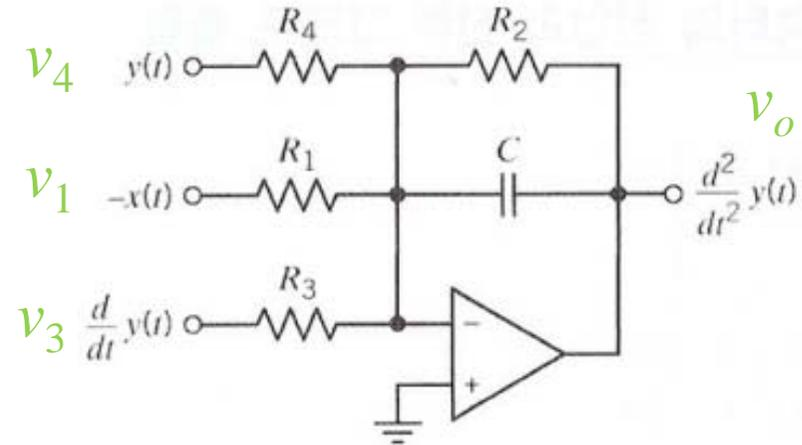
$$\frac{0 - v_1}{R_1} + \frac{0 - v_o}{R_2} + \frac{0 - v_3}{R_3} + \frac{0 - v_4}{R_4} + C \frac{d}{dt} (0 - v_o) = 0$$
