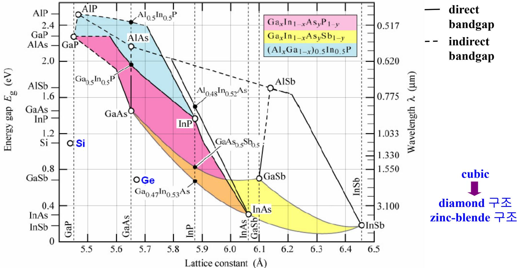
\* 같은 lattice constant를 갖는 반도체 - GaAs/AlAs or InAs/GaSb/AlSb : GaAs substrate
