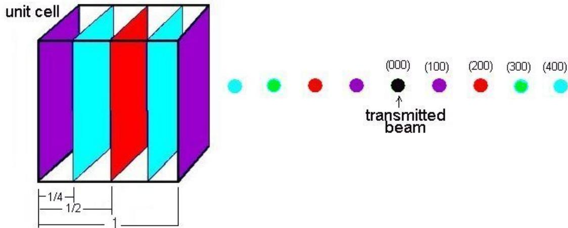
가로방향을 결정의 a축이라고 하고 격자상수가 1이라고 하면 (100)면(그림에서 보라색 결정면)은 역격자 혹은 회절패턴에서  $1/1=1$ 이므로 오른쪽 그림의 보라색 점에 나타나고 이러한 역격자점, 즉 회절패턴의 점들의 방향은 transmitted beam (000)을 출발점으로 하여 선을 그으면 모두 실제 결정면에 수직한 법선의 방향이 된다.
