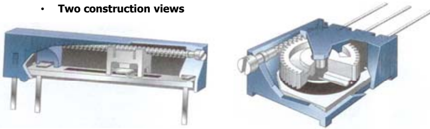
Typical potentiometers and two construction views Floyd 책 45쪽 그림 2.35
