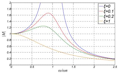
$$\frac{d}{d\omega} \{ \left[1 - \left(\frac{\omega}{\omega_{\rm n}}\right)^2\right]^2 + \left(\frac{2\zeta\omega}{\omega_{\rm n}}\right)^2 \}^2 = 0$$
