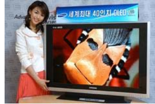
삼성전자 (2005) 40" WXGA (1280×800) HD급 a-Si TFT AMOLED
