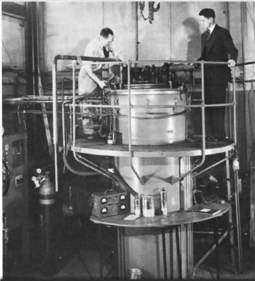
Helium refrigerator-liquefier at MIT
