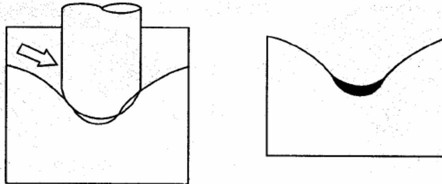
그림 11.24 곡면가공시의 공구간섭 (overcut) 과 undercut.
