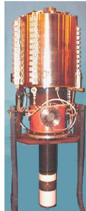
W7-X: CPI (USA) 140 GHz, 0.9 MW 1800 s, 35 %
