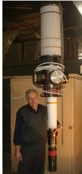
ITER: GYCOM/IAP (RF) 170 GHz, 1.05 (0.83) MW 116 (203) s, 52 (48) %
