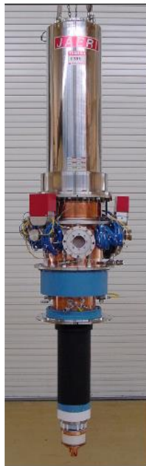
ITER: TOSHIBA/JAEA (JA) 170 GHz, 1 (0.8) MW 800 (3600) s, 55 (57) %
