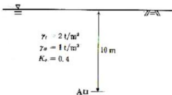
2.10 그림과 같은 지층구조를 갖는 지반에서 지하수위는 지표아래 2m에 있다. 모세관 현상으로 지반은 지표아래 1m까지 포화되었다고 한다. 깊이에 따른 전체 수직응력( $\sigma$ )과 유효수직응력( $\sigma'$ )의 분포도를 지표 아래 10m까지 그려라. 이 지반 위에 단위중량이  $2 t/m^3$ 이고 높이가 4m인 성토층이 범위에 걸쳐서 놓여졌을 때, 성토층이 놓이는 순간과 오랜 기간이 지난 후의 전체 수직응력과 유효수직응력의 분포도를 그려라
