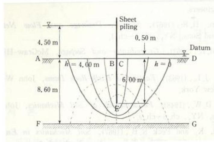
3.7 다음 콘크리트 땅에서의 유선망을 작도하고, 24시간 동안의 유출량을 산정하라. 투수층의  $k = 3.5 \times 10^{-4} \text{ cm/sec}$ 이며, 그림에서 콘크리트 땅의 상류측 지반에 설치된 apron은 차수벽의 역할을 하여 유선의 길이를 연장시켜 하류에서의 파이핑현상에 대한 안정을 위해 설치.
