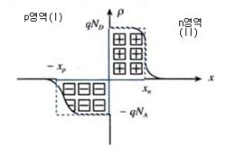
PN 접합을 붙여 열평형 상태가 이루어지면 carrier가 '거의' 존재하지 않아 fixed ion만 존재하는 공핍층(depletion layer)가 그림과 같이 발생하게 된다. 이 공핍층에 의해 발생하는 전기장은 Gauss' Law를 이용하여 구할 수 있는데, 식은 다음과 같다.
