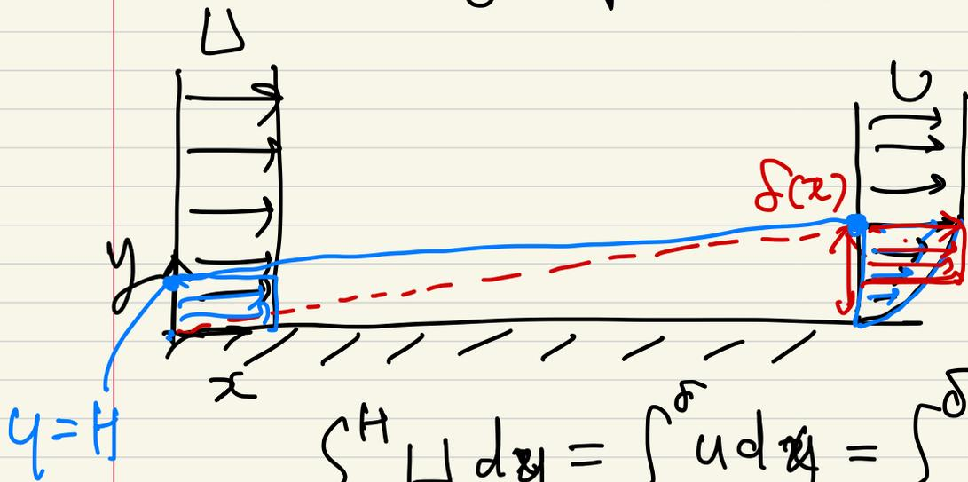
$\delta^*$ : displacement thickness
