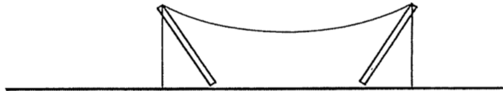
Schrägstütze mit Seil oblique column with cable
