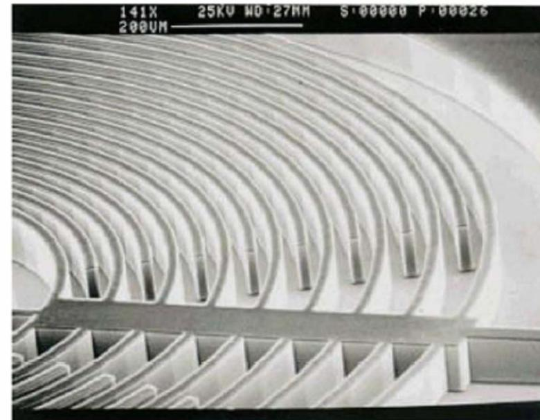
Accelerometer (170  $\mu\text{m}$ -depth)
