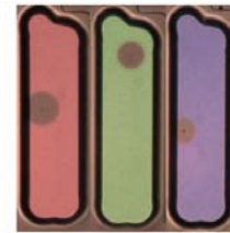
Cathode defect 및 이물에 의한 화소부 축소
