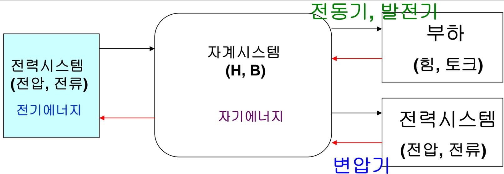
❖ 여러 전기 에너지 변환 시스템들은 **전기 에너지를 기계 에너지로**(예 : 전동기), **기계 에너지를 전기 에너지로**(예 : 발전기) 그리고 **전기 에너지를 전기 에너지로**(예 : 변압기)로 변환 시킬 수 있다.
