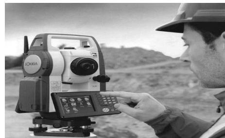
토탈스테이션을 이용한 각, 거리 측량
