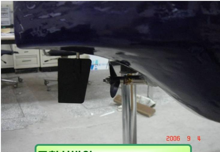
모형선박의 Propeller, Rudder
