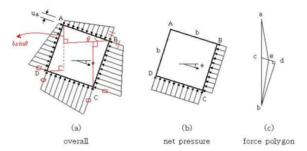
$\circ$   $\overline{AD}$  &  $\overline{BC}$  : Equipotential line
