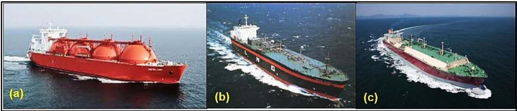
LNG carrier with Spherical (MOSS) tank LNG carrier with Type-C tank LNG carrier with Membrane tank
