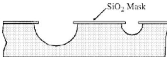
ISOTROPIC WET ETCHING: NO AGITATION
