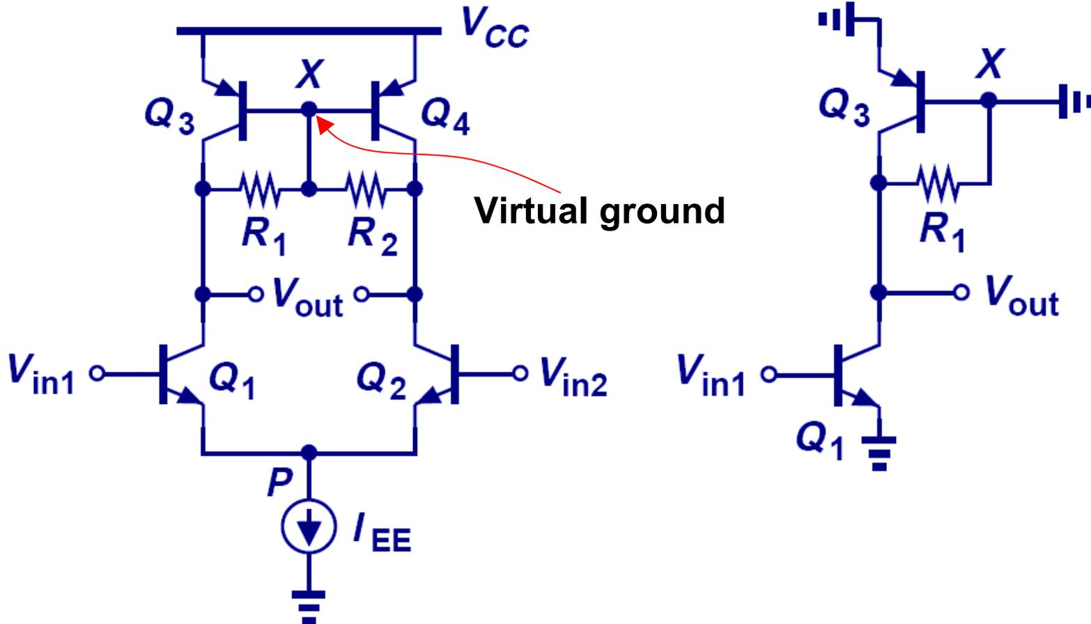
$$A_v = -g_{m1} (r_{O1} \parallel r_{O3} \parallel R_1)$$
