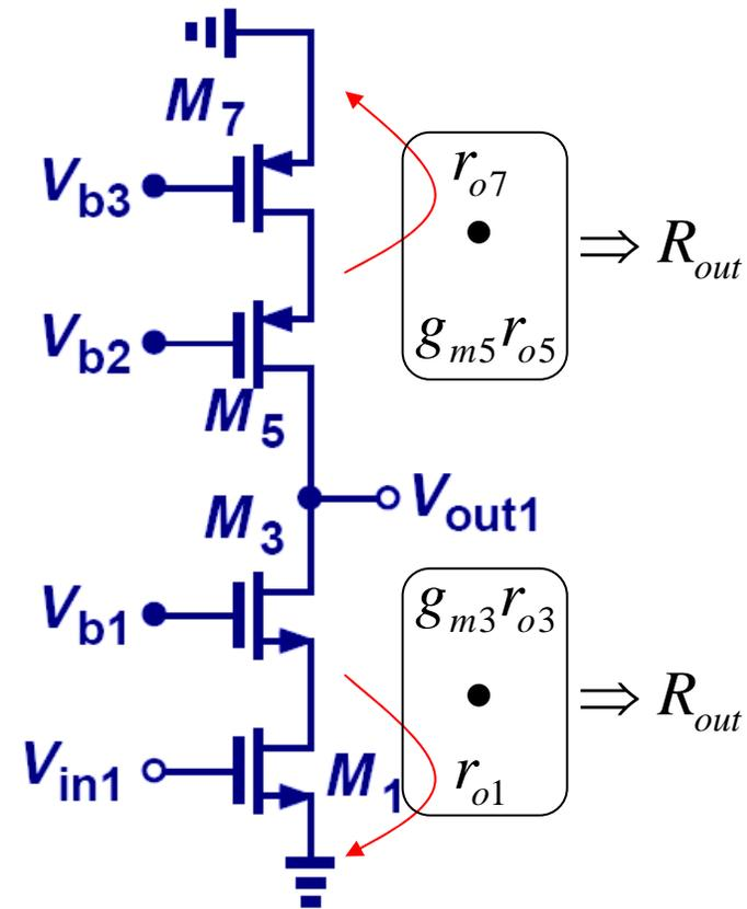
$$A_v \approx -g_{m1} \left[ (g_{m3} r_{o3} r_{o1}) \parallel (g_{m5} r_{o5} r_{o7}) \right]$$
