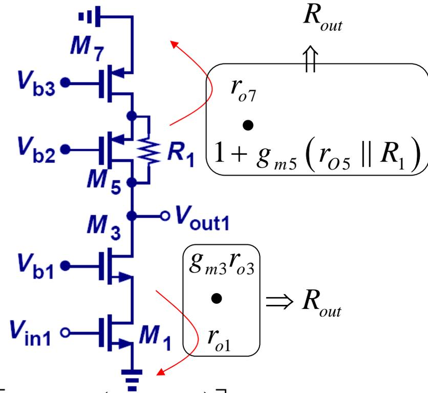
$$R_{op} \approx \left[ 1 + g_{m5} (r_{o5} \parallel R_1) \right] r_{o7}$$
