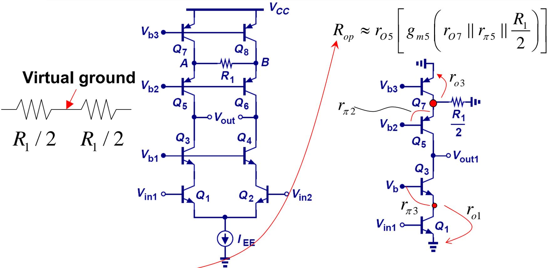
$$R_{op} = r_{O5} \left[ 1 + g_{m5} \left( r_{O7} \parallel r_{\pi 5} \parallel \frac{R_1}{2} \right) \right] + r_{O7} \parallel r_{\pi 5} \parallel \frac{R_1}{2}$$
