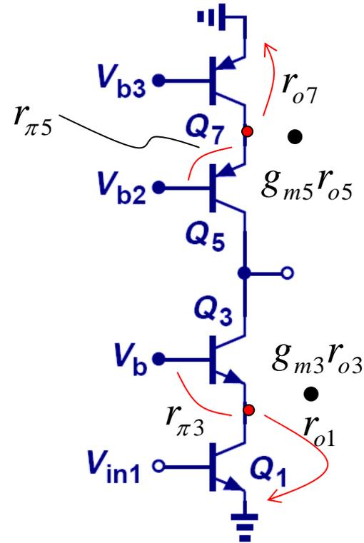
$$A_v \approx -g_{m1} \left[ g_{m3} r_{o3} (r_{o1} \parallel r_{\pi3}) \right] \parallel \left[ g_{m5} r_{o5} (r_{o7} \parallel r_{\pi5}) \right]$$
