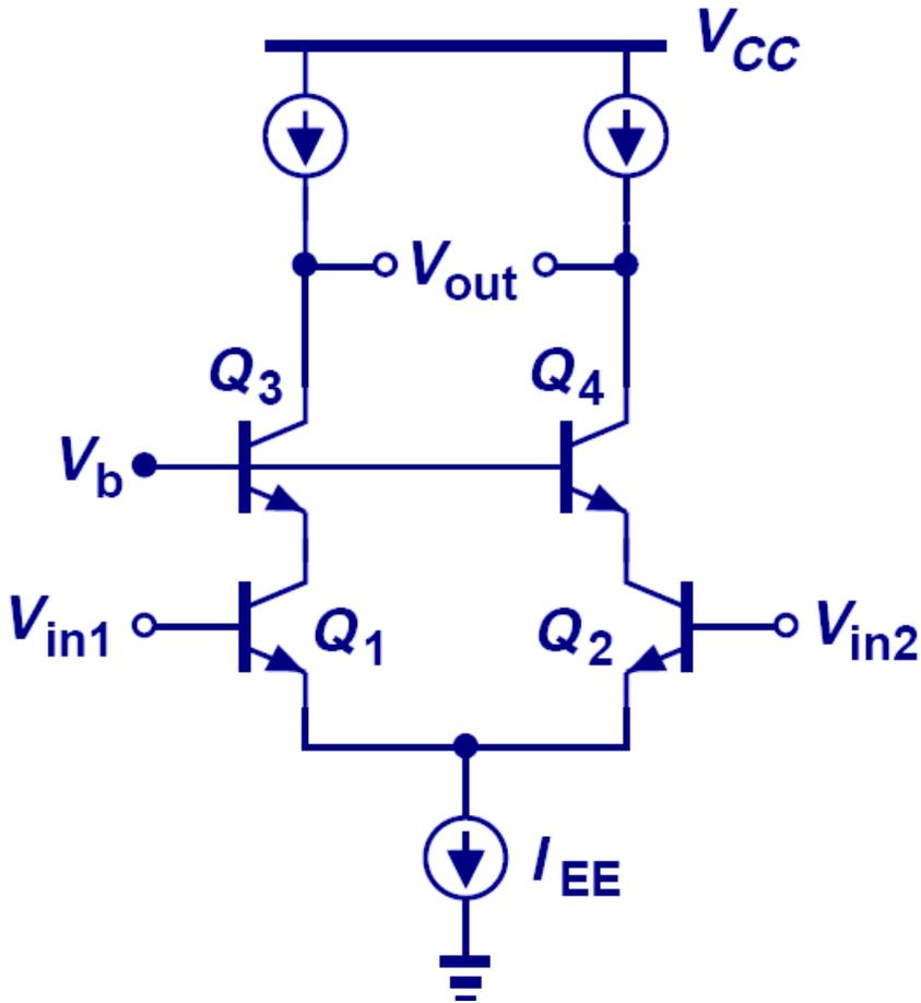
$$A_v = -g_{m1} \left[ (r_{O1} \parallel r_{\pi3}) (g_{m3} r_{O3} + 1) \right]$$
