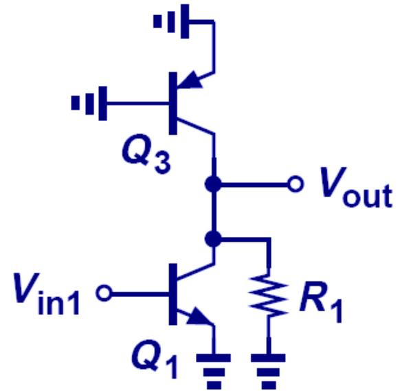
$$A_v = -g_{m1} (r_{O1} \parallel r_{O3} \parallel R_1)$$
