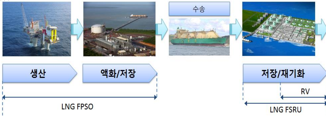
LNG Supply Chain에 따른 LNG 해양플랫폼 개념구분 (images from Statoil, Ingfacts.org, wikipedia, kogas.or.kr)
