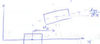
$$v(x, y, z) = v_0 - y \frac{dv}{dx} - z \frac{dw}{dx}$$
