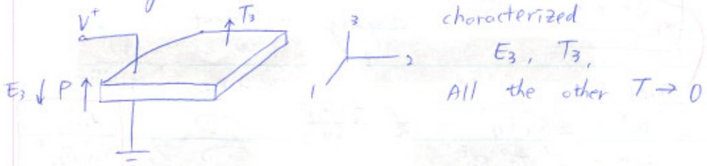
$$\begin{Bmatrix} S_3 \\ D_3 \end{Bmatrix} = \begin{bmatrix} d_{33}^E & d_{33}^T \\ d_{33}^T & \epsilon_{33}^T \end{bmatrix} \begin{Bmatrix} T_3 \\ E_3 \end{Bmatrix}$$
