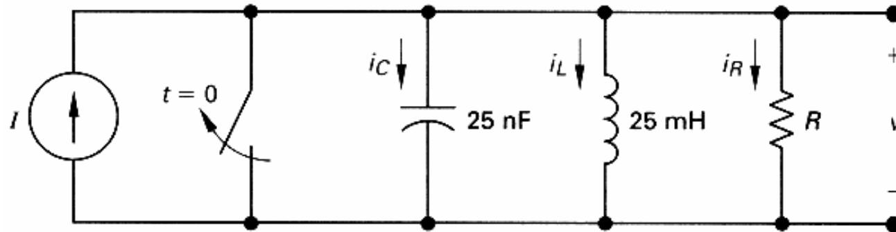
$$a) i_L(0^+) = ? \quad i_L(0^-) = 0 \quad \text{이므로} \quad i_L(0^+) = i_L(0^-) = 0.$$
