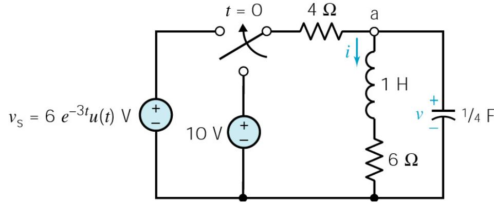
$$\left( \frac{di_L}{dt} + 6i_L \right) - v_s + 4i_L + \frac{d}{dt} \left( \frac{di_L}{dt} + 6i_L \right) = 0$$
