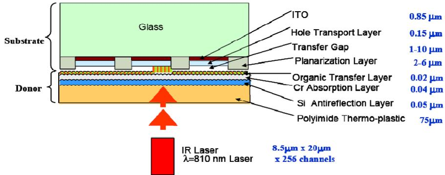
도너필름과 기판 간격이 일정하게 유지되도록 1-10 $\mu\text{m}$ 의 spacer를 삽입하며, 40 nm의 크롬 흡수층을 포함하는 도너필름에 고에너지의 레이저빔을 스캔하여 진공 중에서 도너필름에 도포된 유기물질이 승화되어 기판으로 이동되도록 하는 기술
