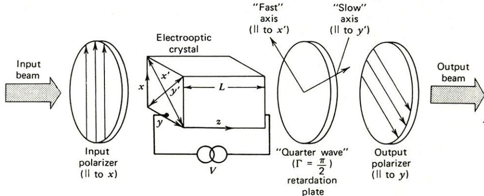
$$\rightarrow \mathbf{E}' = \begin{pmatrix} 1 & 0 \\ 0 & 0 \end{pmatrix} \begin{pmatrix} \cos \frac{1}{2}\Gamma & -i \sin \frac{1}{2}\Gamma \\ -i \sin \frac{1}{2}\Gamma & \cos \frac{1}{2}\Gamma \end{pmatrix} \frac{1}{\sqrt{2}} \begin{pmatrix} 0 \\ 1 \end{pmatrix}$$
