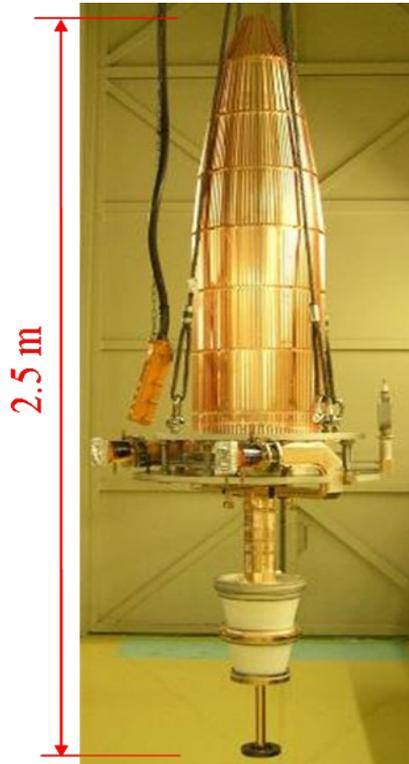
**500 kW klystron for ITER**
