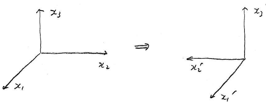
$$R = \begin{bmatrix} x_1 & x_2 & x_3 \\ 1 & 0 & 0 \\ 0 & -1 & 0 \\ 0 & 0 & 1 \end{bmatrix} \begin{bmatrix} x_1' \\ x_2' \\ x_3' \end{bmatrix}$$
