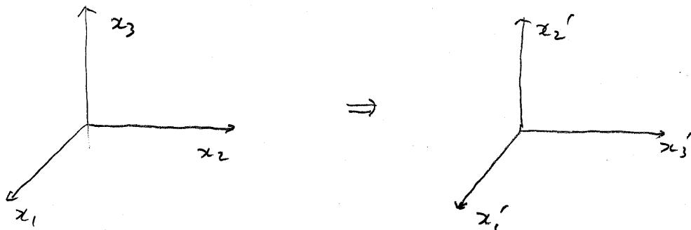
$$R = \begin{bmatrix} x_1' & x_2' & x_3' \\ 1 & 0 & 0 \\ 0 & 0 & 1 \\ 0 & 1 & 0 \end{bmatrix} \begin{bmatrix} x_1' \\ x_2' \\ x_3' \end{bmatrix}$$
