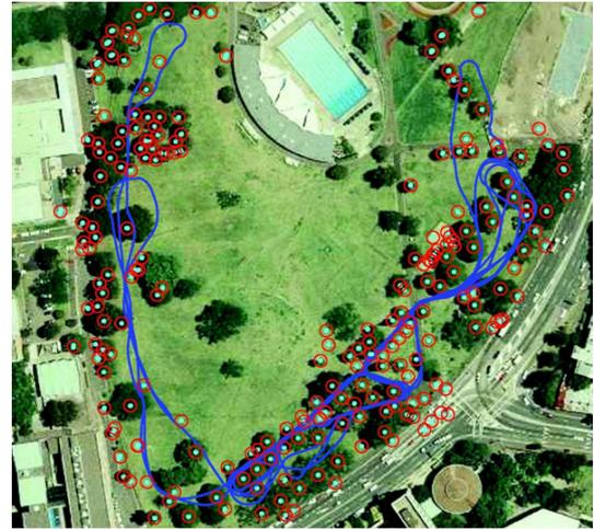
[그림 16] SLAM 기반 지도 생성 및 이동 로봇 위치 추정
