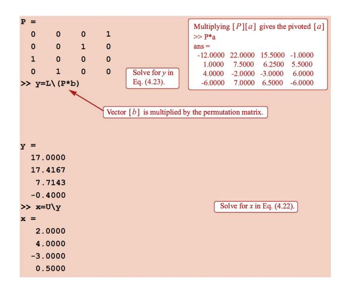
Ax=b LU=PA  $P^T LUx=b$  L[Ux]=PbSolve Ly=PbThen Ux=y
