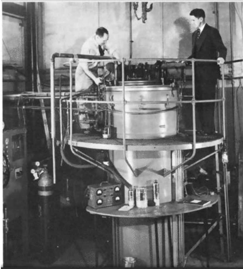
Helium refrigerator-liquefier at MIT
