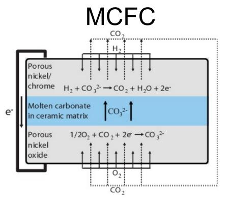
Anode:  $H_2 + CO_3^{2-} \to CO_2 + H_2O + 2e^-$ Cathode:  $\frac{1}{2}O_2 + CO_2 + 2e^- \to CO_3^{2-}$
