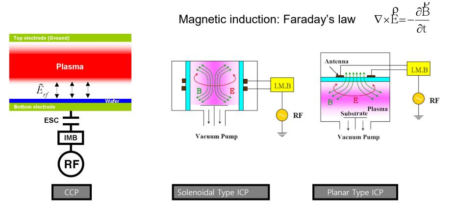
RF Coil current → Chamber 내부에 時變 자기장 생성
