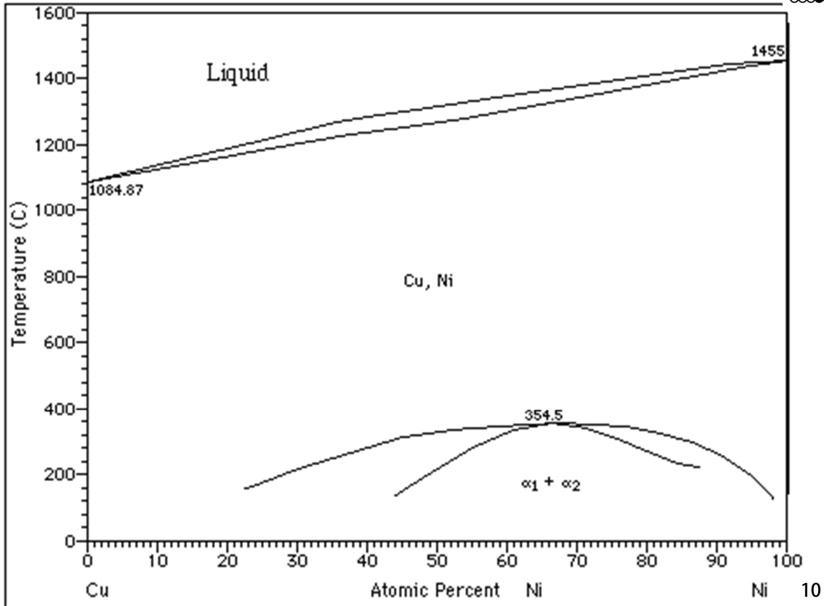
$\epsilon > 0$ ,  $\Delta H_{\text{mix}} > 0$  /  $\Delta H_{\text{mix}} \sim +17 \text{ kJ/mol}$
