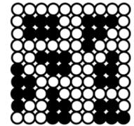
$\epsilon > 0$ ,  $\Delta H_{\text{mix}} > 0$  /  $\Delta H_{\text{mix}} \sim +5 \text{ kJ/mol}$
