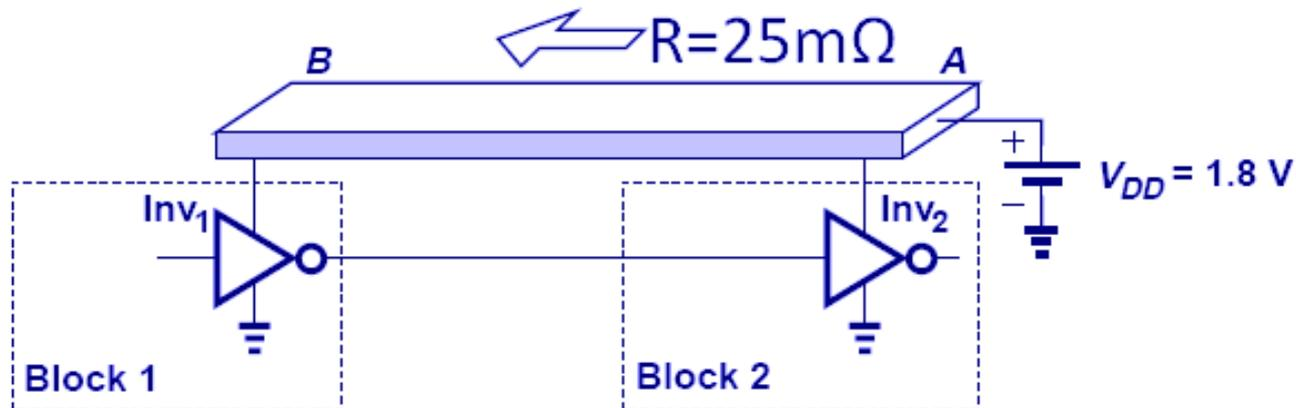
$$\Delta V = 5\text{A} \times 25\text{m}\Omega = 125\text{mV}$$
