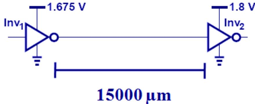
**Wire Capacitance per Micron:  $50 \text{ aF}/\mu\text{m}$ , ( $1 \text{ aF} = 1 \times 10^{-18} \text{ F}$ )**
